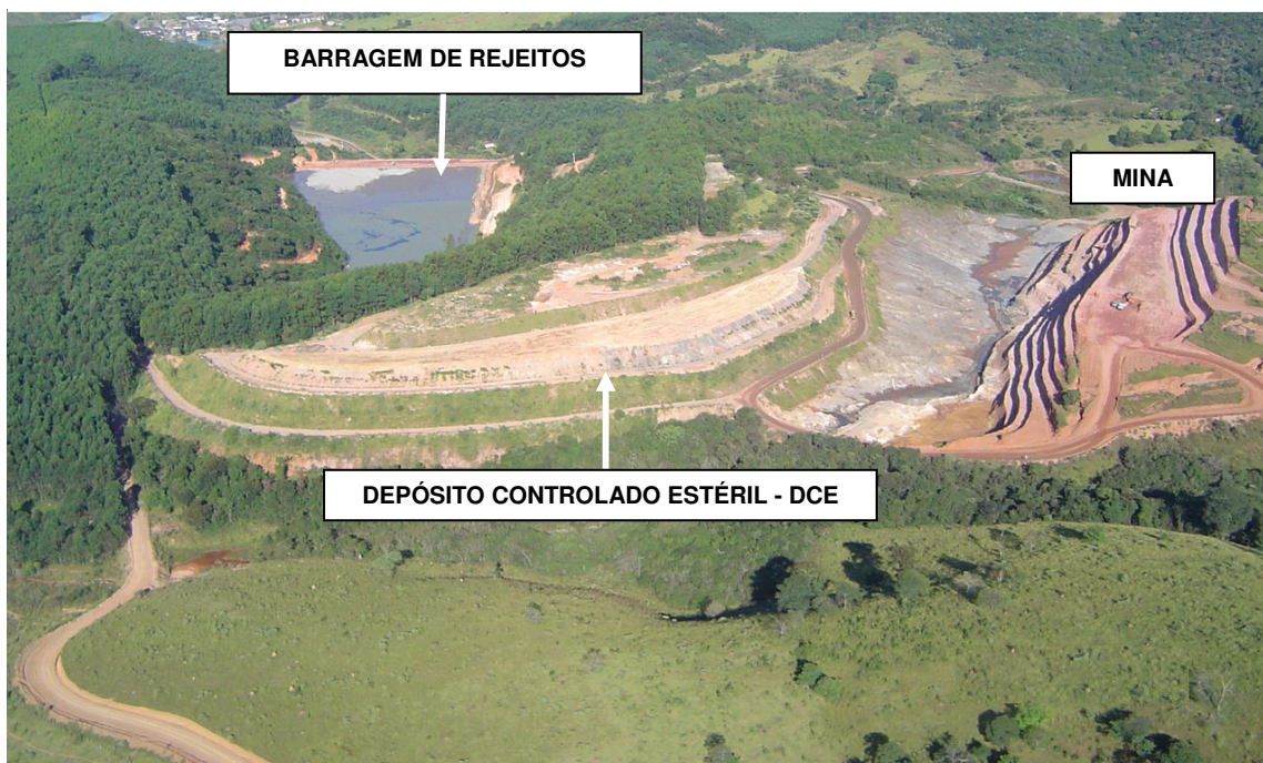
FIGURA 3 – Visão geral da mina de grafite e da disposição dos resíduos gerados na lavra (estéril) e no beneficiamento do minério(rejeito) FONTE: Dados da pesquisa 2009
