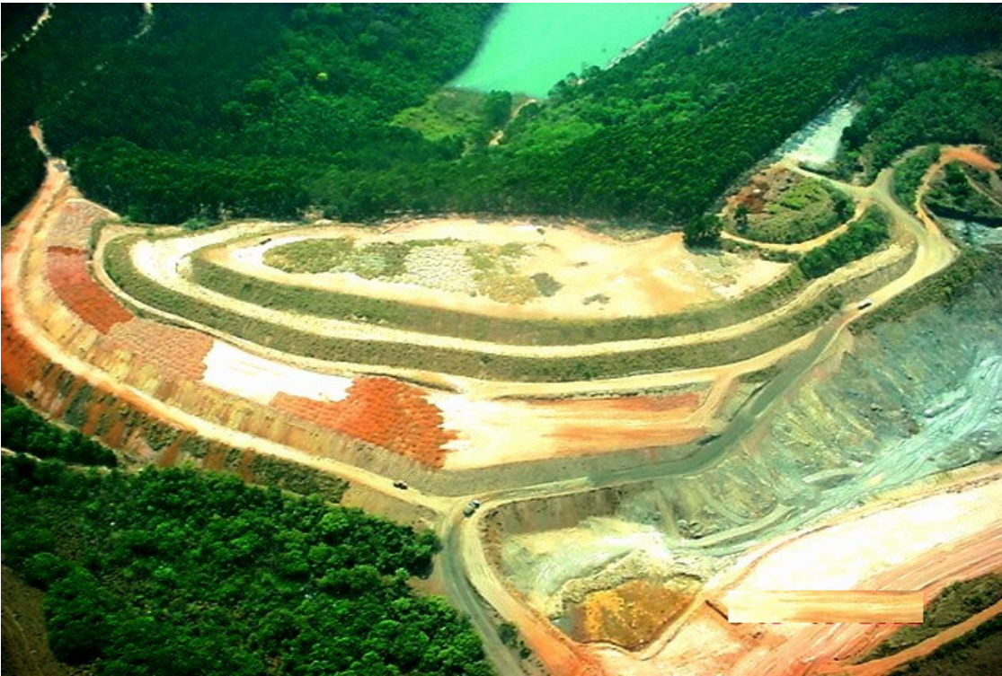
FIGURA 2 – Frente de lavra e depósito controlado de estéril ( DCE) - Mina de grafite FONTE: Dados da pesquisa 2009
