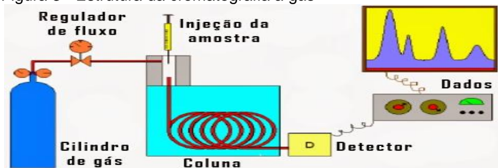
Figura 3 - Estrutura da cromatografia a gás
