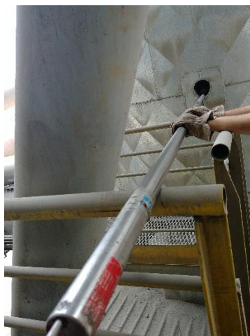
Figura 18 - Tubo de pitot e ponto de análise
