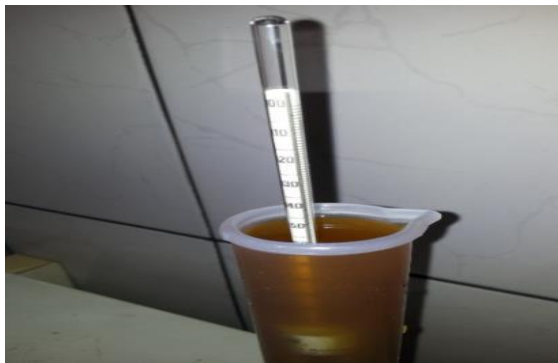
Figura 26-Medição da densidade
