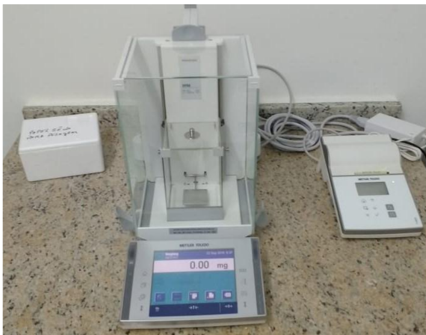
Figura 5 - Balança analítica utilizada na pesagem dos comprimidos para o teste de friabilidade
