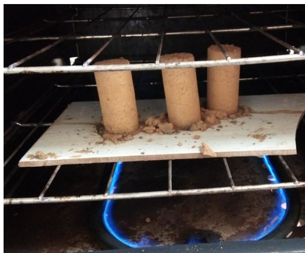
Figura 14 - Forno a gás utilizado na queima
