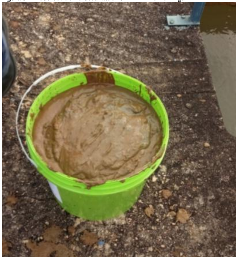
Figura 5 – Lodo obtido no decantador 01 ETA Rio Formiga
