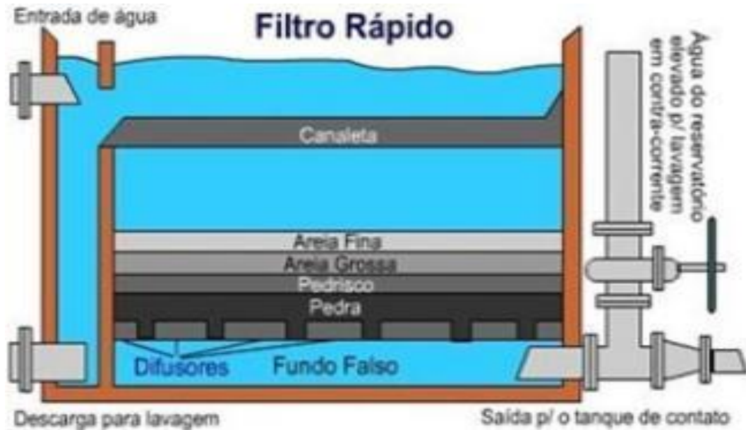
Figura 4 - Sistema de filtração rápida.
