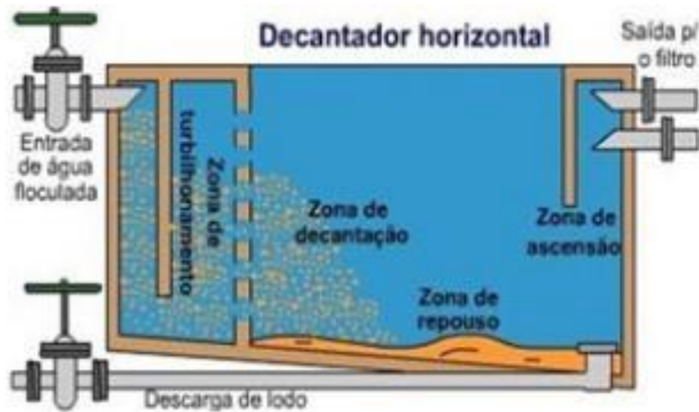
Figura 3 – Sistema de decantação horizontal.
