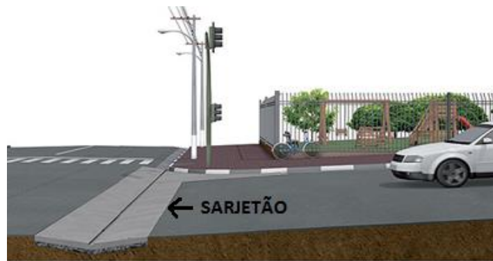
Figura 4 - Sarjetão de concreto armado
