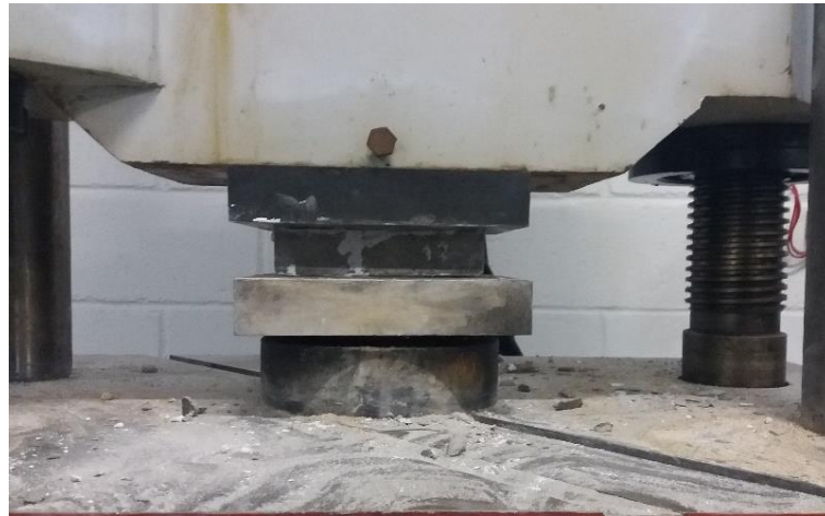
FIGURA 6 - CORPO DE PROVA SENDO ROMPIDO.
