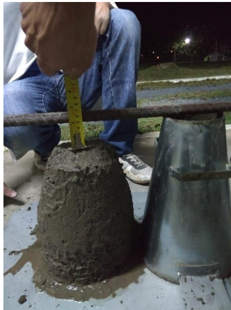
Figura 10 - Teste abatimento tronco de cone (Slump test)
