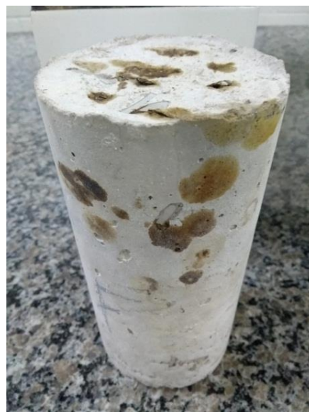
Figura 16 - Corpo de prova com adição de PET exposto a 700 °C
