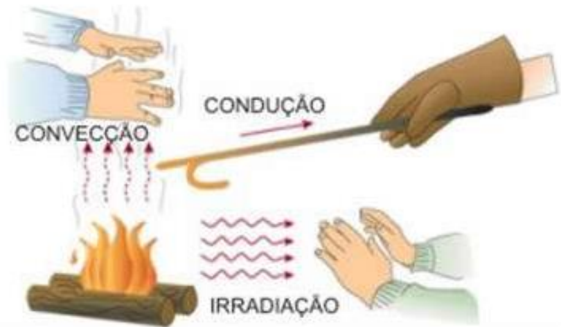
Figura 4 - Métodos de transferência de calor.
