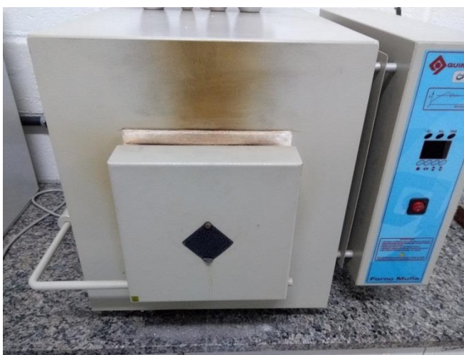
Figura 13 - Equipamento utilizado para aquecer os corpos de prova
