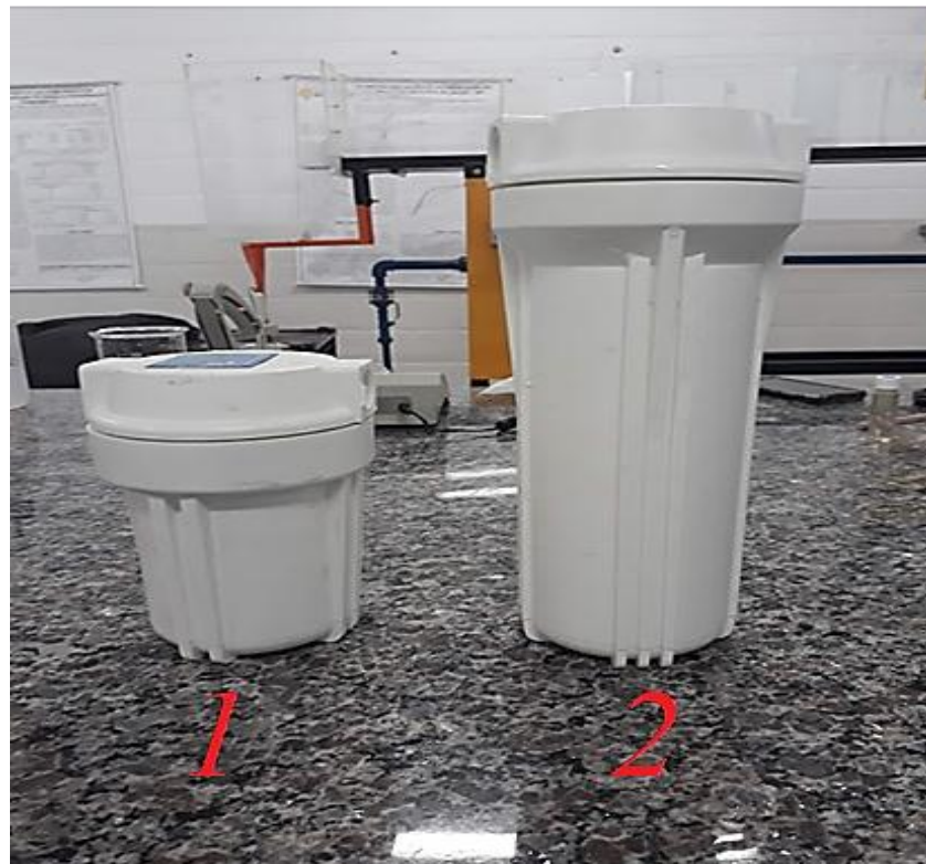
Figura 3 - Filtros decoloradores 1 (menor) e 2 (maior) utilizados para a decoloração da água
