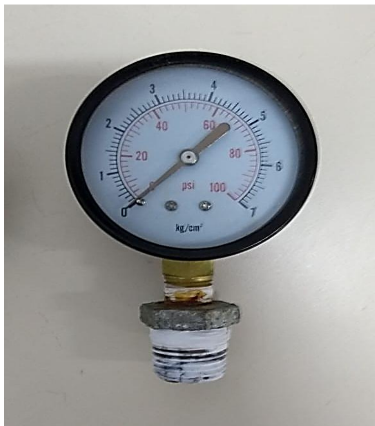
Figura 4 - Manômetro de Bordon instalado depois do filtro declorador
