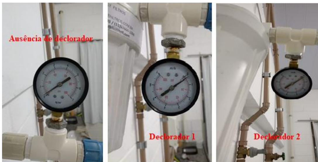
Figura 5 - Retratação e comparação da leitura do manômetro
