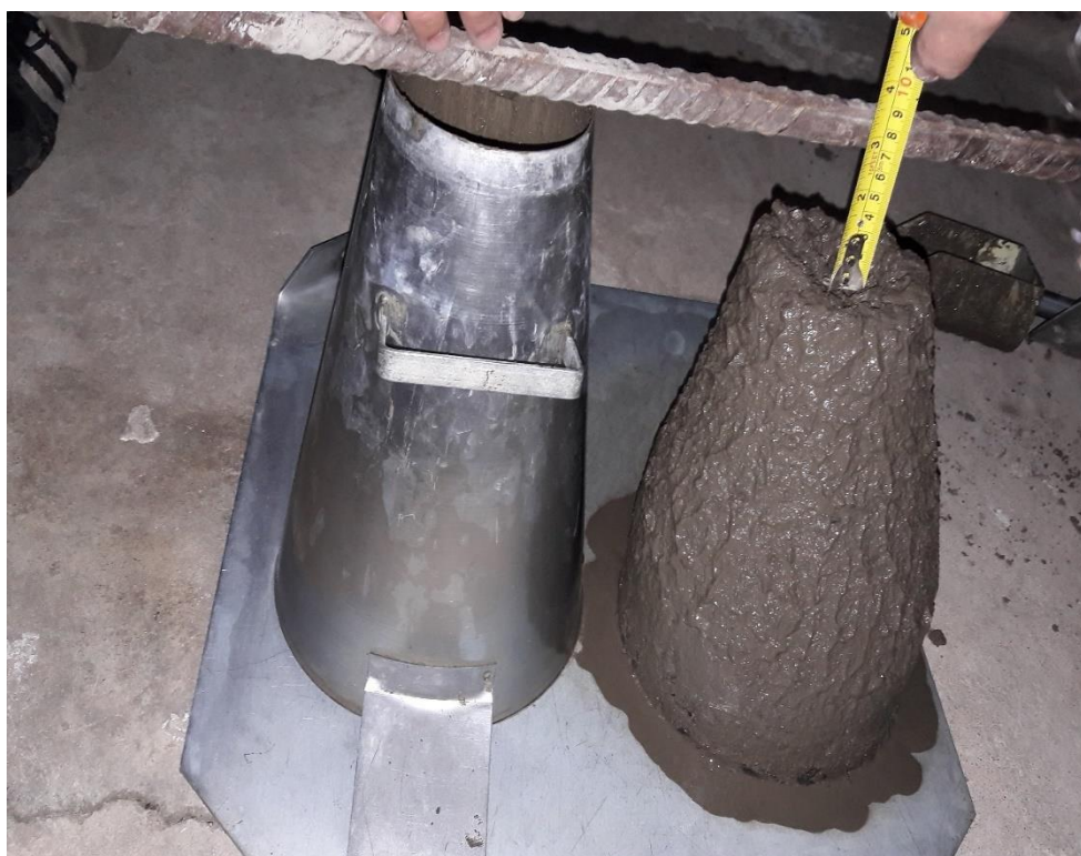
Figura 4- Realização do teste de abatimento do tronco de cone ( Slump Test )
