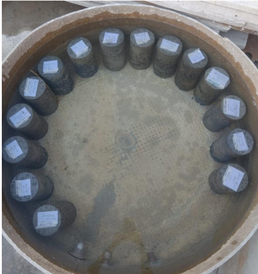
Figura 5 – Cura dos corpos de prova de concreto.
