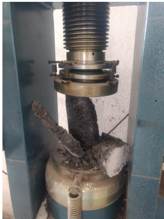
Figura 6 – Corpo de prova rompido na prensa.
