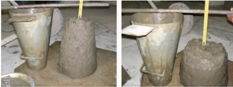
Figura 2 – Ensaio de abatimento de tronco ( slump test )
