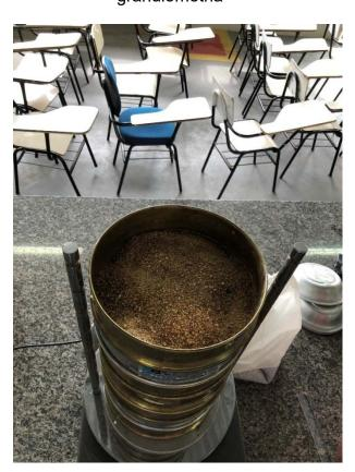
**Figura 4 -** Realização do ensaio de granulometria
