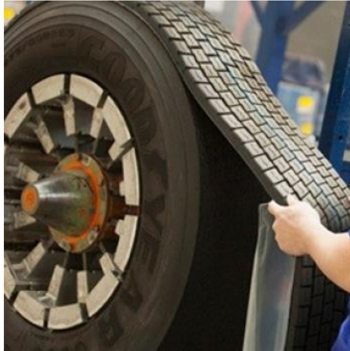
Figura 2 – Processo da recauchutagem do pneu
