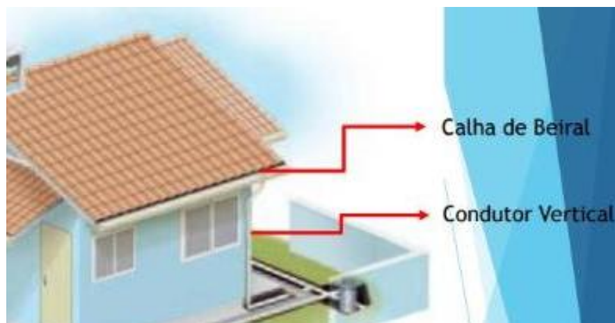
Figura 10 – Calha e tubulação
