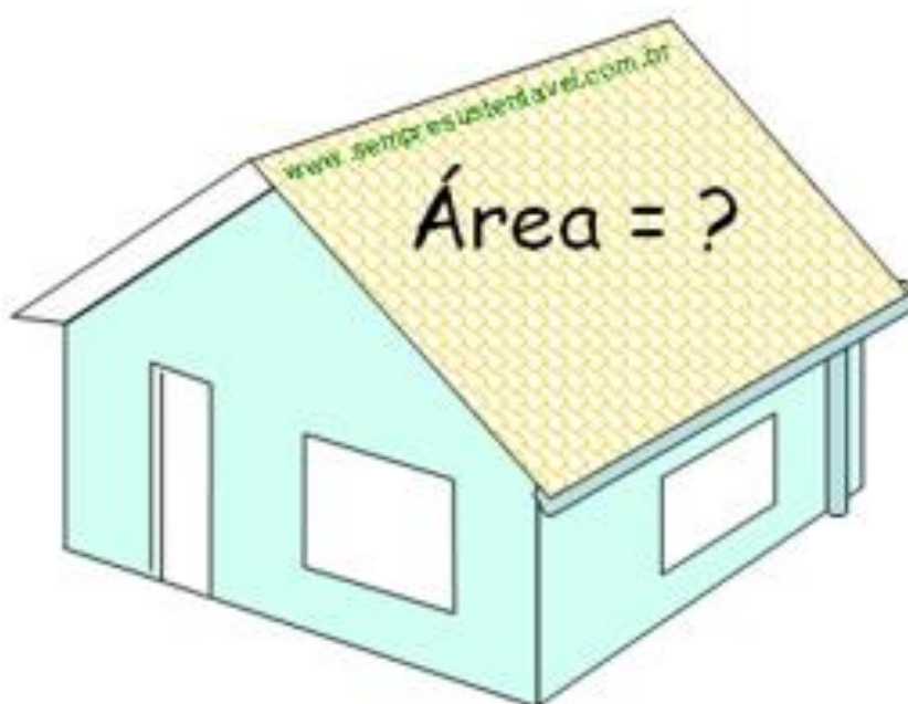
Figura 8 - Área de captação de chuva no telhado
