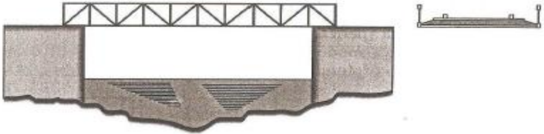
Figura 8 - Ponte em treliça
