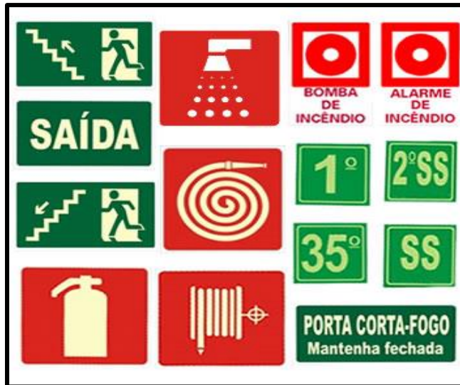
Figura 9 - Exemplos de sinalização de emergência
