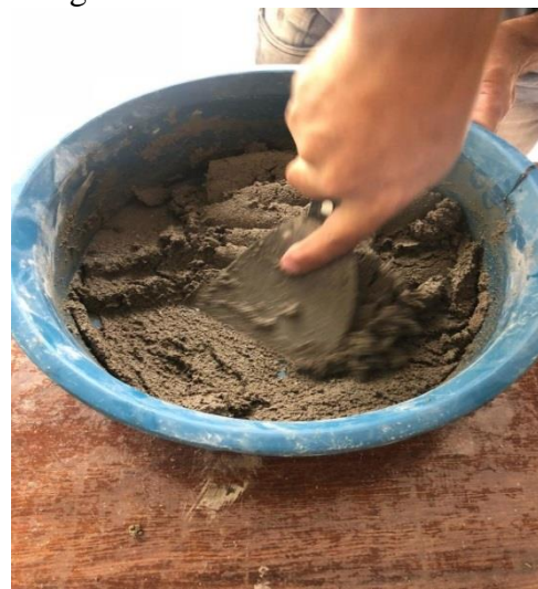
(b) Amassamento da Argamassa
