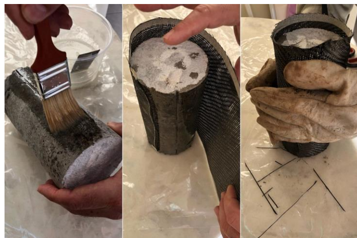
Figura 5 – Colagem da fibra de carbono no corpo de prova.
