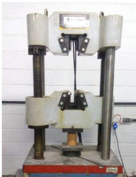
Figura 12 – Ruptura dos corpos de prova em máquina universal de ensaios
