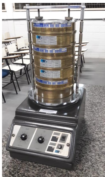
Figura 5 – Execução do peneiramento fino
