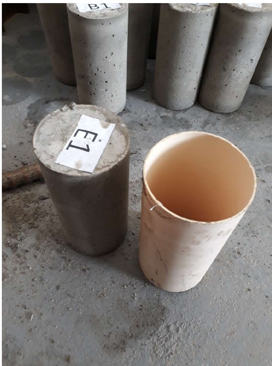
Figura 12 - Retirada dos moldes dos corpos de prova
