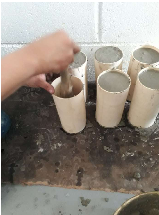
Figura 11 - Adensamento manual do concreto para confecção dos corpos de prova
