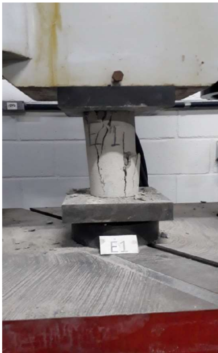
Figura 14 – Rompimento dos corpos de prova
