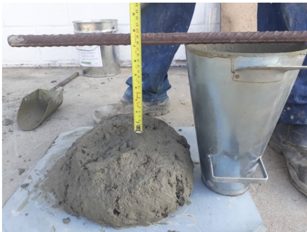
Figura 10 - Realização do teste de abatimento do tronco de cone ( slump test )
