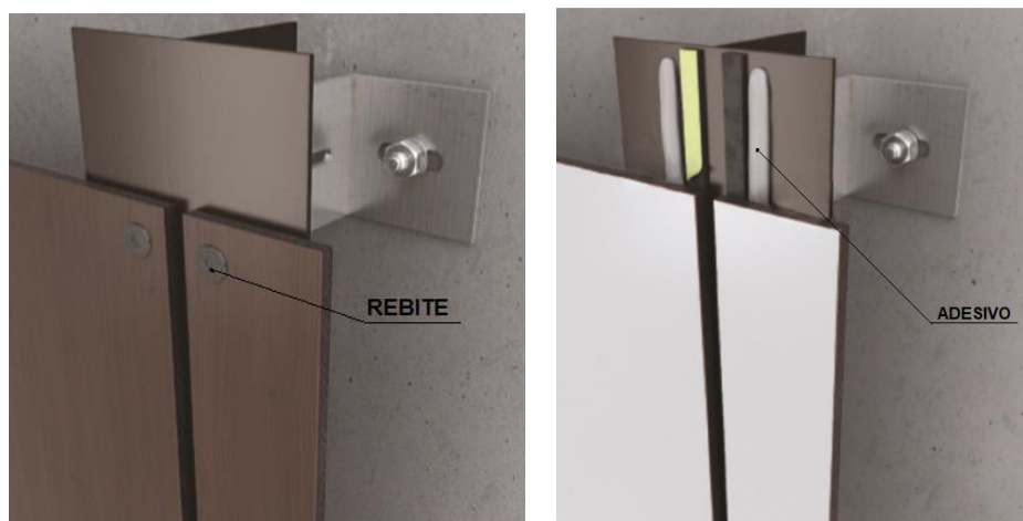
Figura 14 - Dispositivo de fixação rebite e adesivo estrutural
