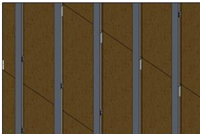
Figura 20 - Fixação do isolante termo acústico
