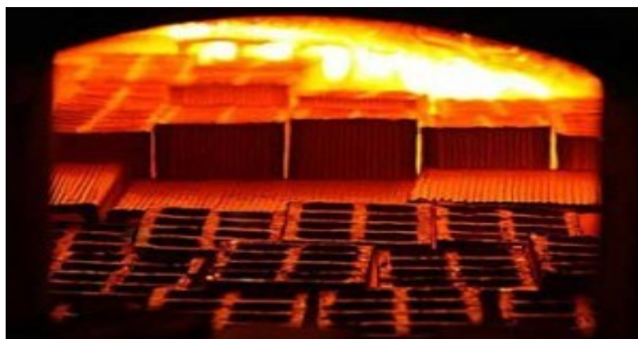
Figura 6 - Queima dos blocos cerâmicos
