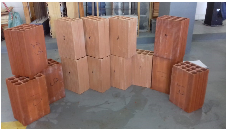
Figura 9 - Blocos da empresa A e B identificados para inspeção e realização dos ensaios
