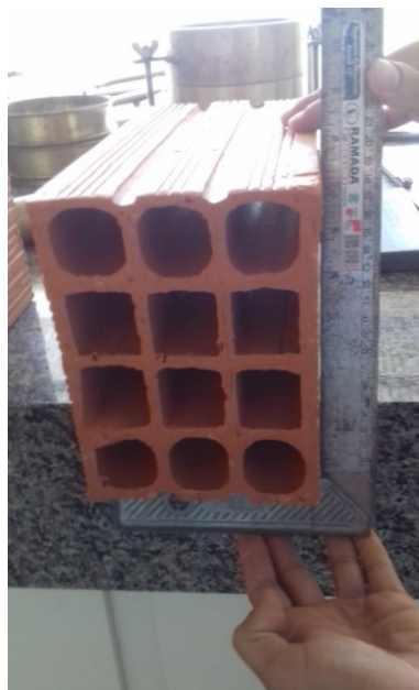
Figura 17 - Medição do desvio em relação ao esquadro
