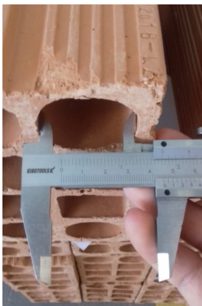
Figura 14 - Medição do septo de um de um bloco cerâmico
