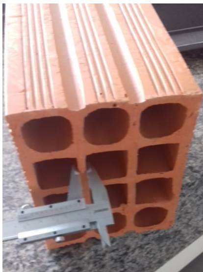
Figura 15 - Medição da parede interna de um bloco cerâmico
