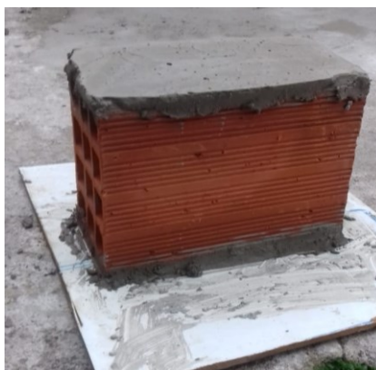
Figura 22 - Bloco regularizado para o ensaio de resistência a compressão
