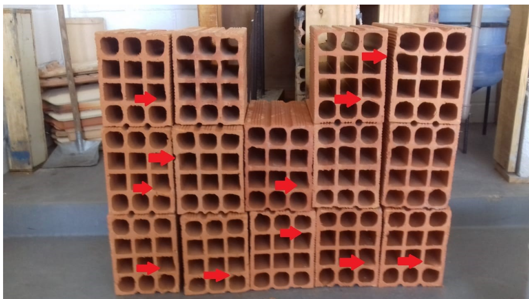
Figura 24 - Anomalia nos septos dos blocos da empresa A
