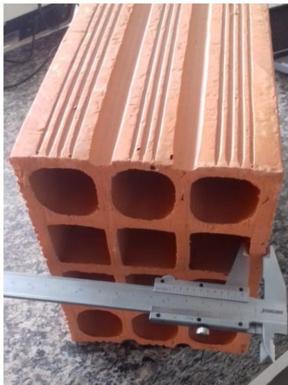
Figura 13 - Medição da parede externa de um bloco cerâmico
