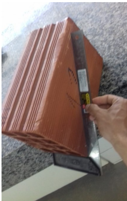
Figura 19 - Medição da planeza das faces dos blocos cerâmicos
