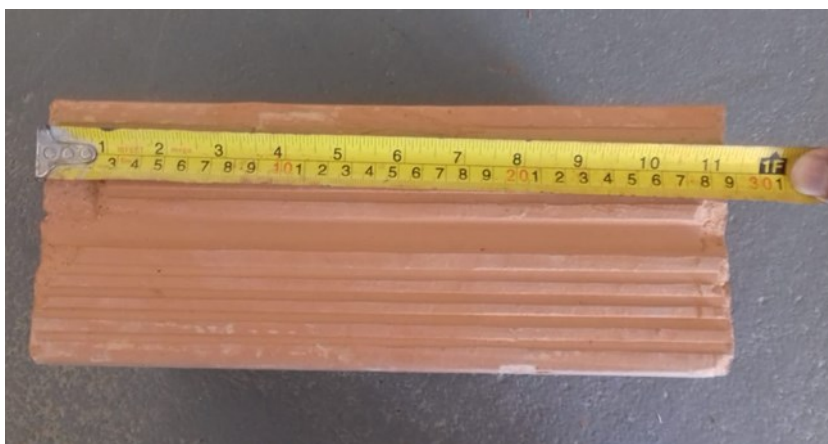
Figura 11 - Medição do comprimento do bloco cerâmico
