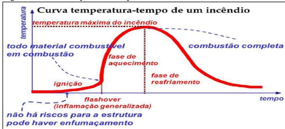
Figura 1 - Curva temperatura-tempo de um incêndio.
