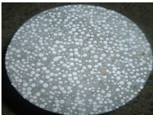
Figura 1 - Concreto com pérolas de EPS
