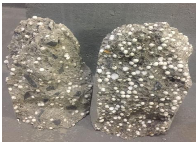
Figura 12 – Corpos de provas com EPS rompidos
