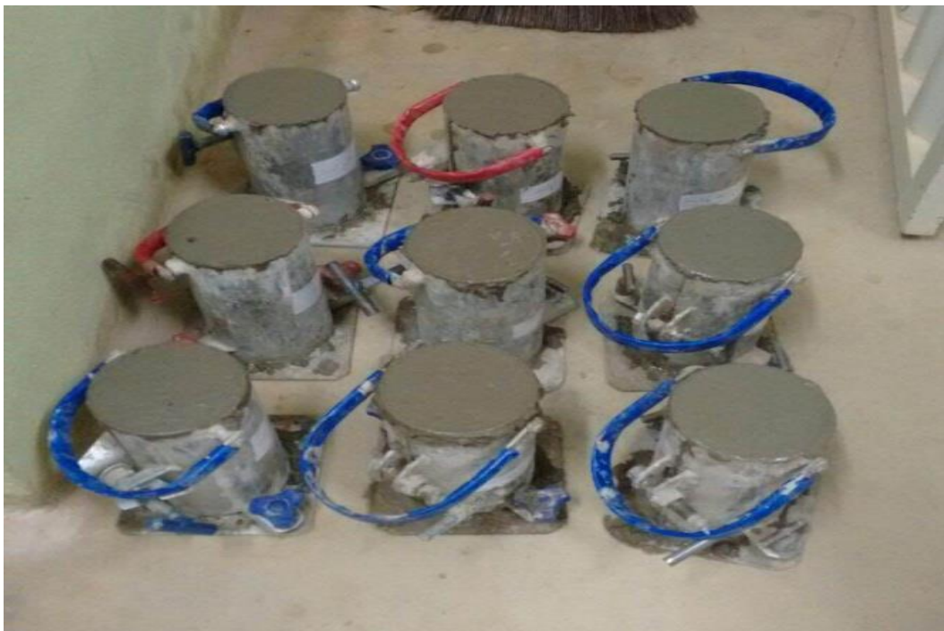
Figura 6 - Cura inicial do concreto
