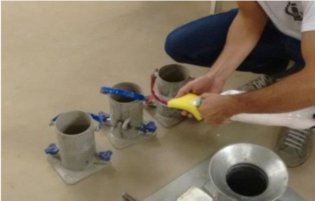
Figura 5 - Montagem dos corpos de prova
