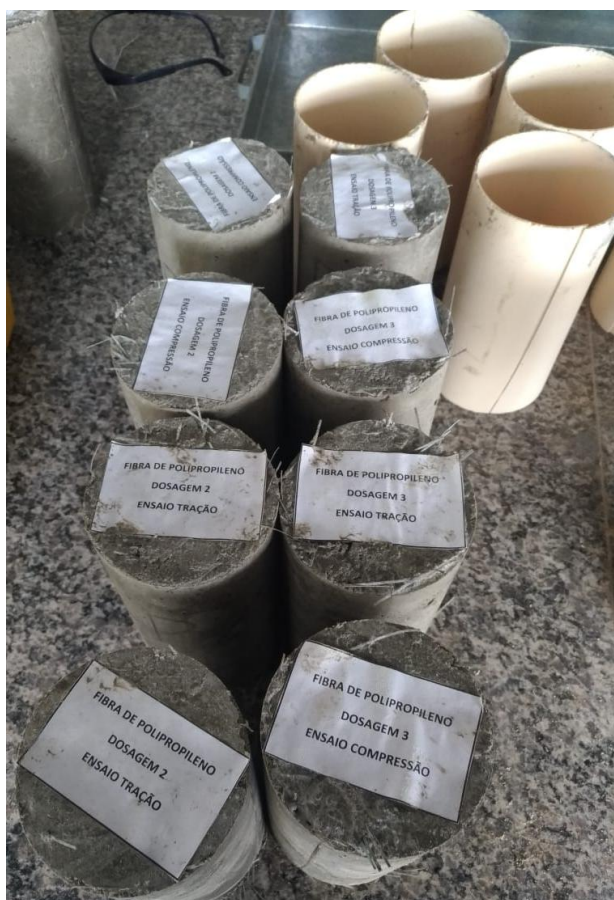
Figura 16 - Alguns corpos de prova que foram desmoldados pelo auxílio da lixadeira
