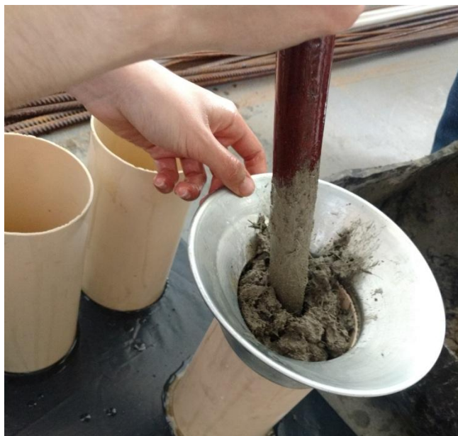
Figura 15 - Adensamento manual do concreto
