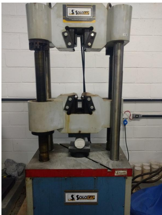
Figura 21 - Ensaio de resistência à tração por compressão diametral
