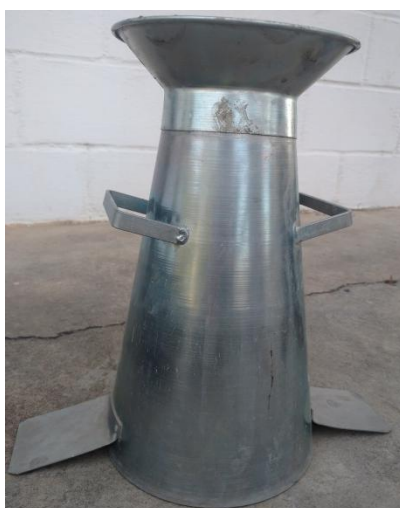
Figura 14 - Molde metálico utilizado para a realização do Slump Test
