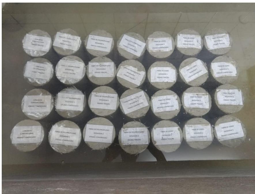
Figura 17 - Cura úmida dos corpos de prova
