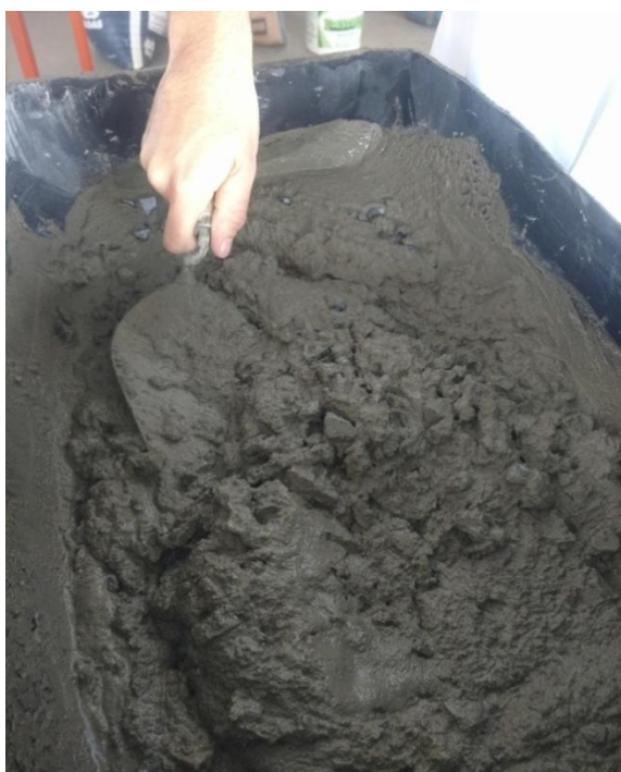
Figura 13 - Mistura de forma manual dos materiais
