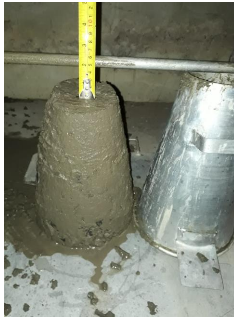
Figura 6-Realização do teste de abatimento do tronco de cone ( slump test )
