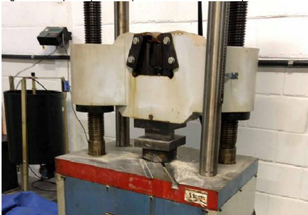
Figura 6 - Corpo de prova na prensa antes de seu rompimento
