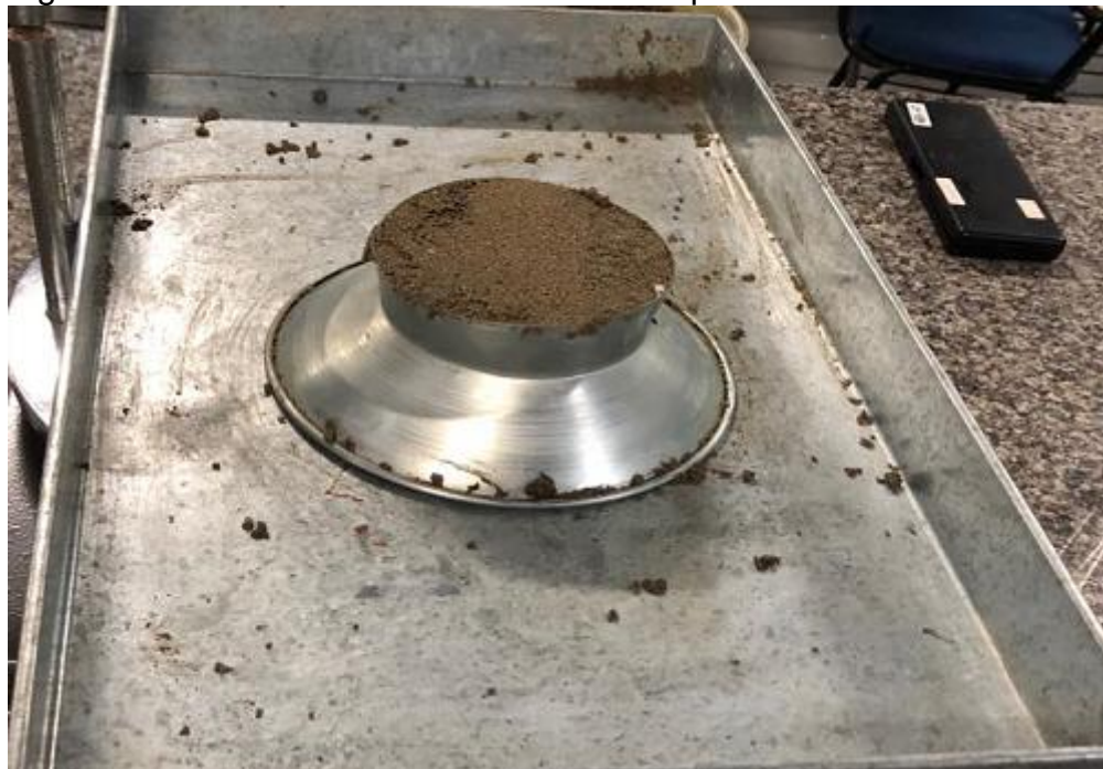
Figura 2 - Molde de ensaio de consistência preenchido
