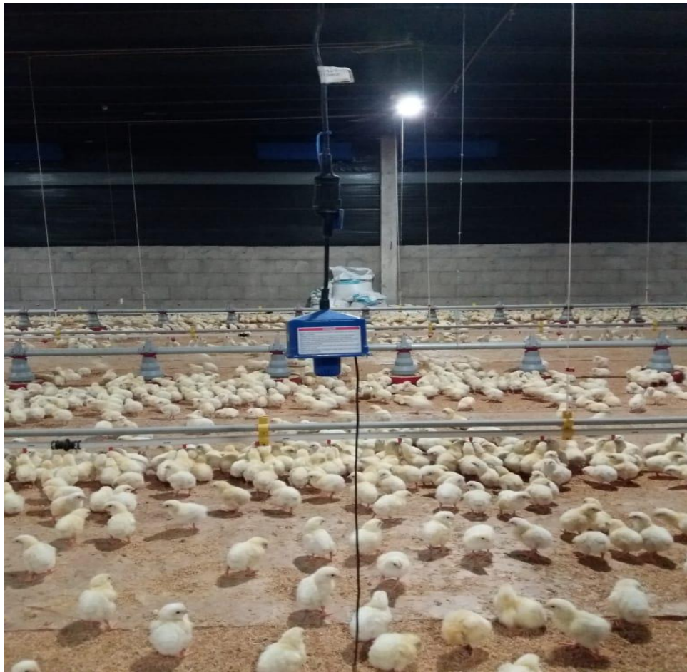
Figura 4 - Modelo de sonda distribuída em três pontos distintos a 37m, 75m e 112m da entrada de ar do aviário.
