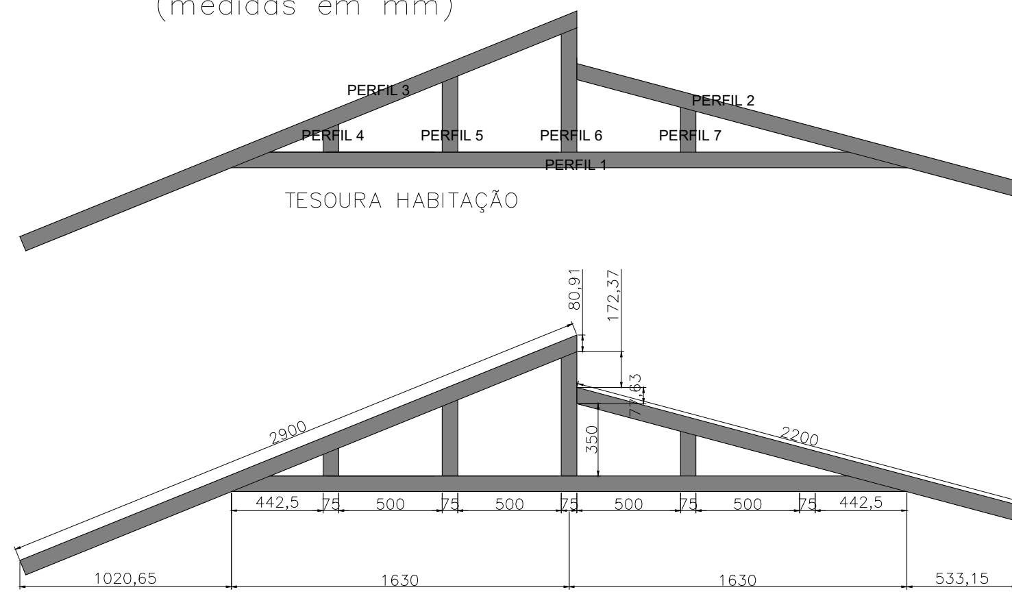
MEDIDAS TESOURA HABITAÇÃO Escala 1/25 (medidas em mm)
