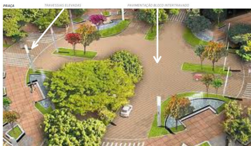
Figura 55 – Imagem ilustrativa do projeto de elevação de pista com execução de pavimentação em blocos intertravados de concreto e das travessias elevadas.
