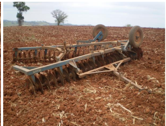
FIGURA 6: Implemento agrícola utilizado para fazer a gradeação (grade roma). Fonte: Dados da pesquisa 2010
