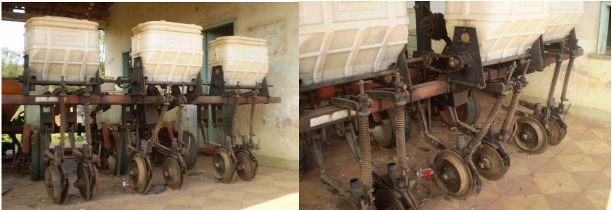
FIGURA 9: Cultivador tracionado por trator utilizado para a adubação de cultura de grãos. Fonte: Dados da pesquisa 2010
