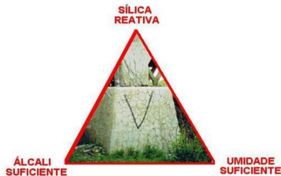
Figura 16: Fatores necessários para a reação álcali-sílica.
