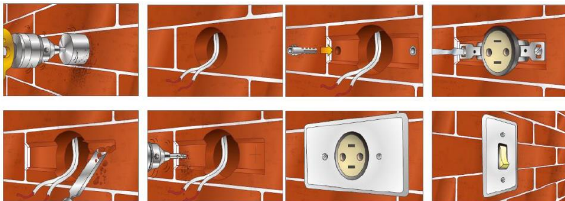
Figura 40 - Execução da instalação elétrica
