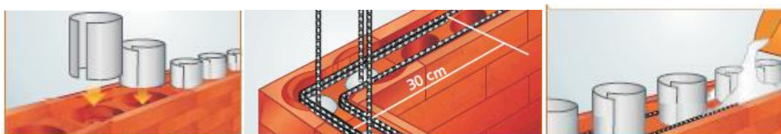
Figura 39 - Execução das vigas de amarração
