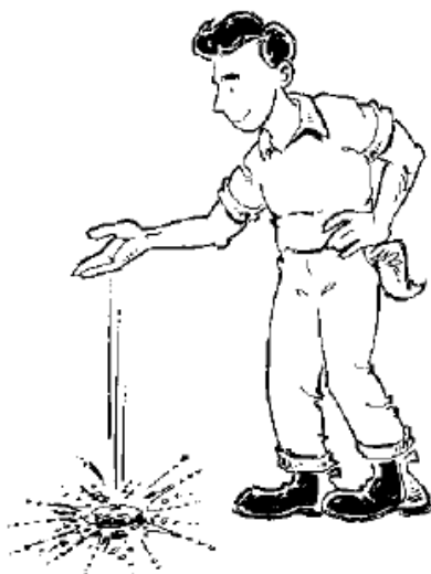
Figura 4 - 2ª verificação da umidade da mistura – queda sobre a superfície
