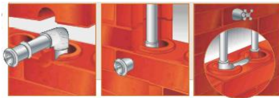
Figura 41 - Execução da instalação hidráulica
