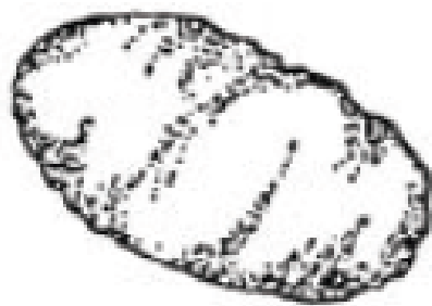
Figura 6 - 2ª verificação da umidade da mistura – água em excesso
