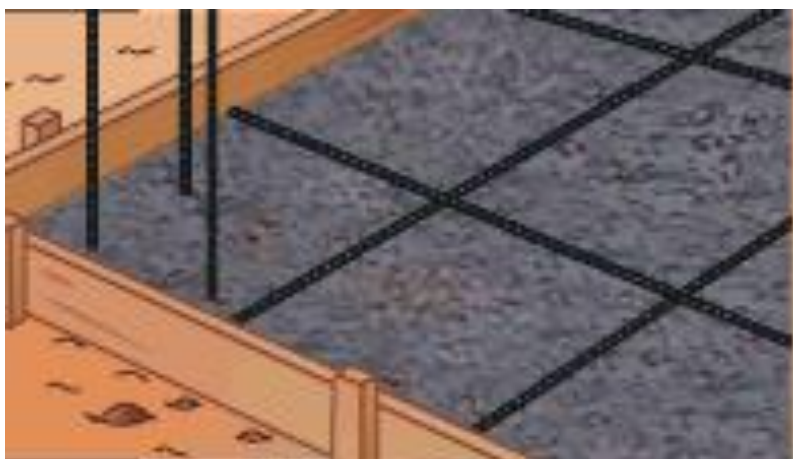
Figura 25 - Fixação dos vergalhões de aço na fundação
