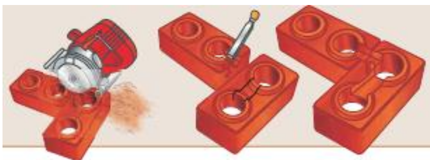
Figura 34 - Criação de aberturas nos tijolos
