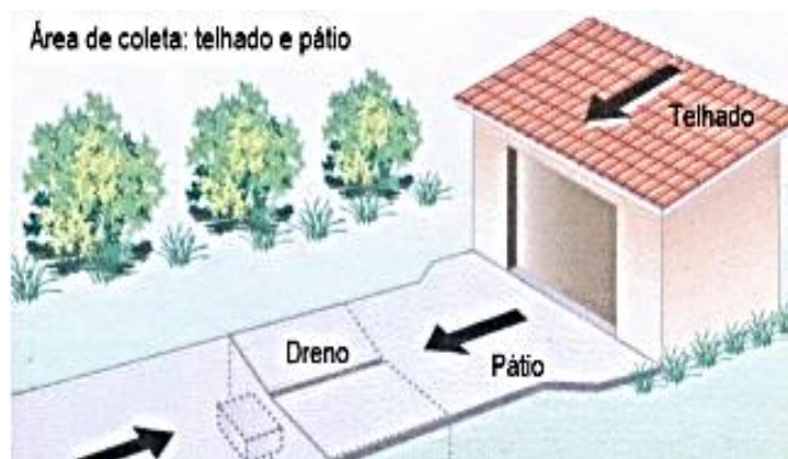
Figura 6 – Áreas de captação de água de chuva: telhado e pátio.
