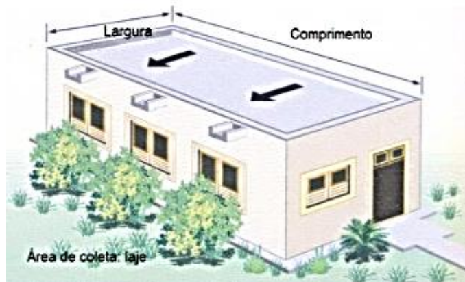
Figura 5 – Áreas de captação de água de chuva: laje.
