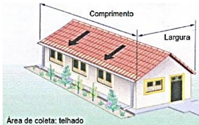
Figura 4 – Áreas de captação de água de chuva: telhado.
