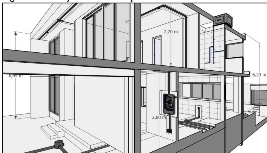
Figura 32 - Projeto de Instalações elétricas e hidrossanitárias
