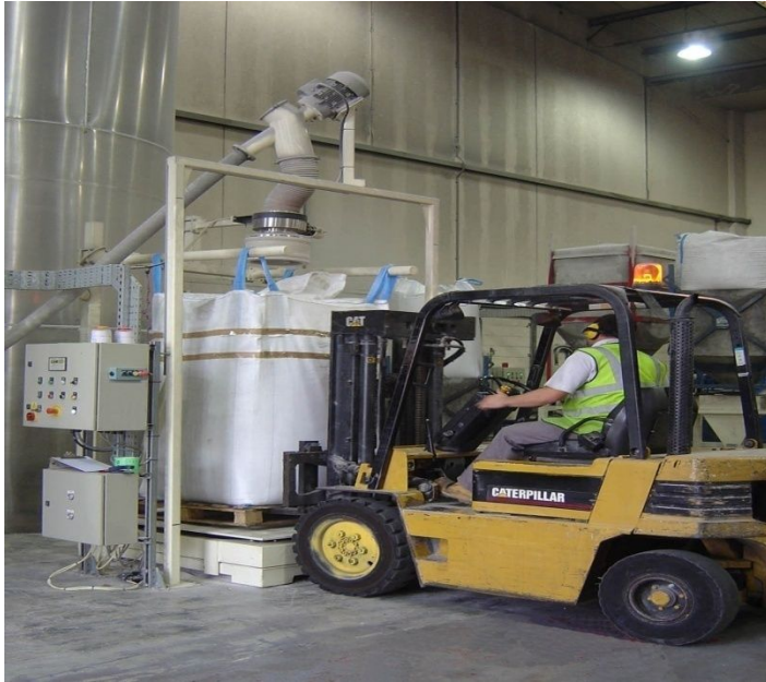
Figura 11: Carregamento da embalagem big bag de Rafia
