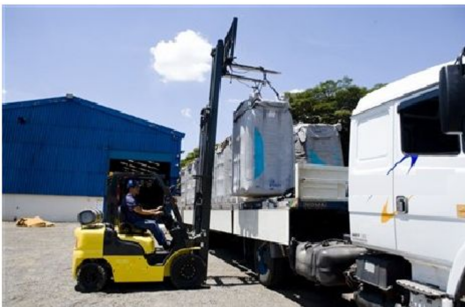
Figura 12: Descarregamento da embalagem big bag de PVC
