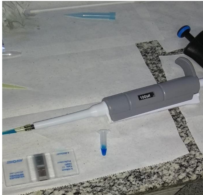
Figura 16 – Mistura da amostra/corante na Câmara de Neubauer.
