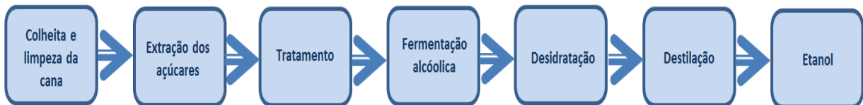
Figura 4 - Processo de produção de etanol a partir de cana-de-açúcar
