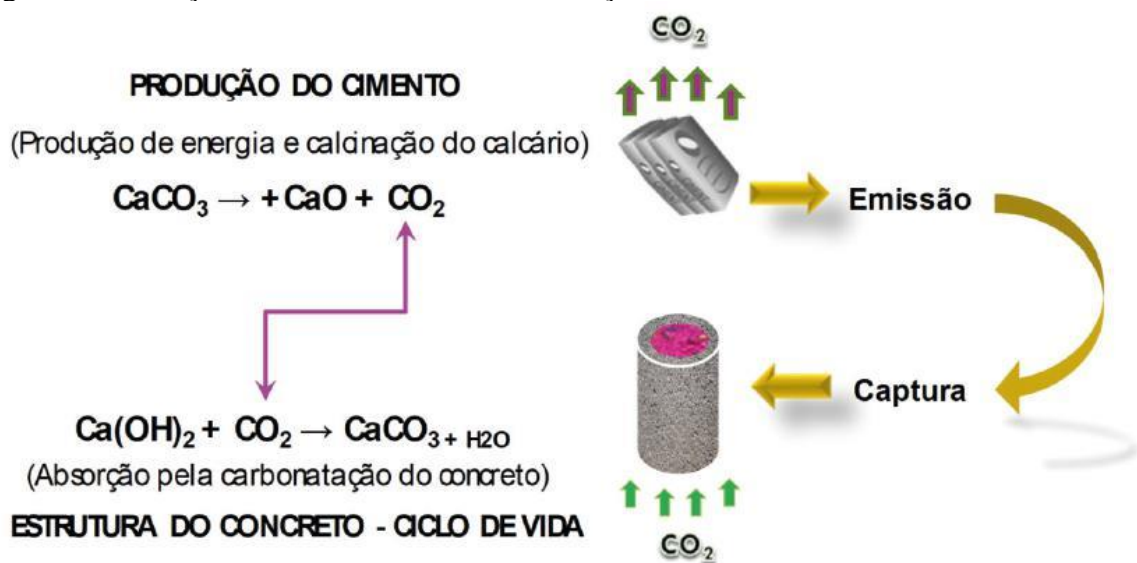
Figura 5 - Produção de cimento versus carbonatação do concreto.
