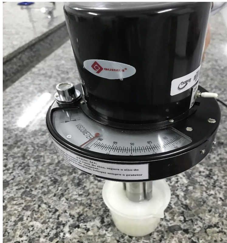
Figura 11- medição de viscosidade do xampu da amostra produzida.
