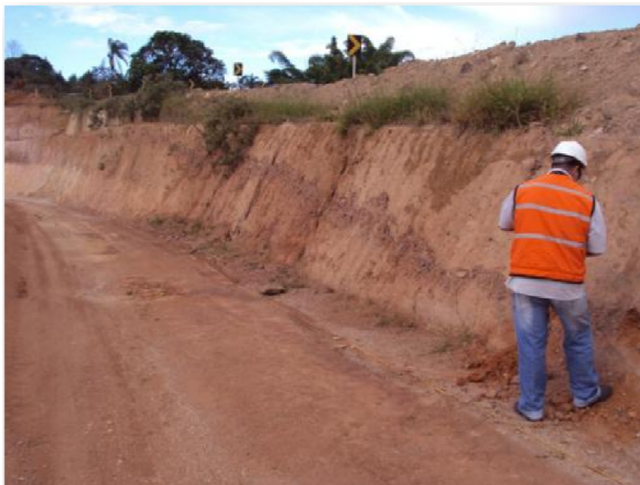
FIGURA 18 – Veio de quartzo em meio a solo residual maduro de migmatito (SRMMI) Fonte: Arquivo da empresa
