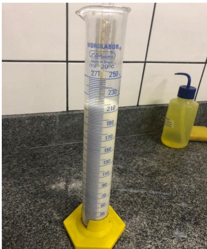
Figura 5 - Averiguação da densidade do leite a 15°C
